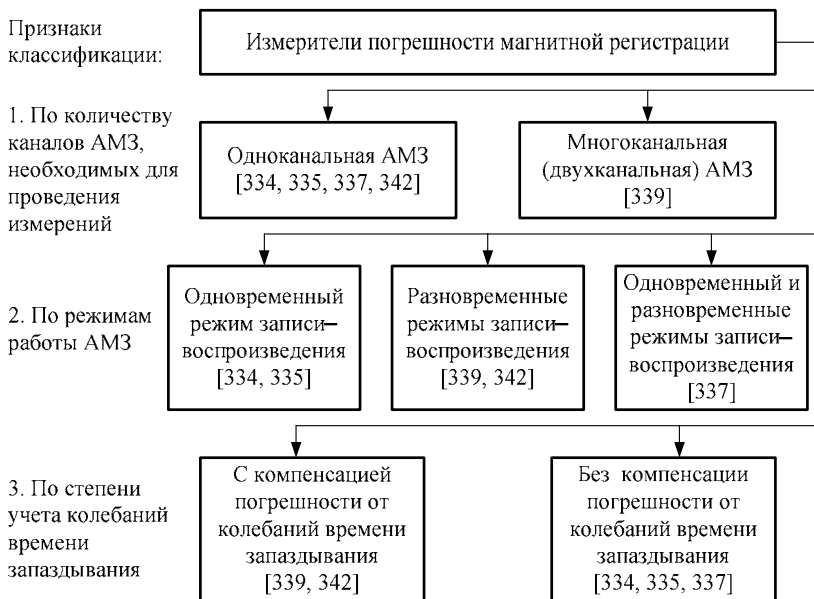
Рис. 2.4. Классификация измерителей погрешности магнитной регистрации
