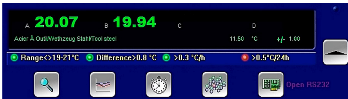
Рисунок 3.3 – Окно ПО системы температурной компенсации
