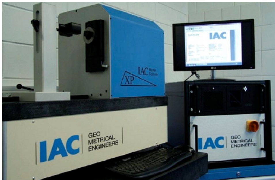
Рисунок 1.18 – Общий вид измерителя параметров резьбовых и гладких калибров MasterScanner
