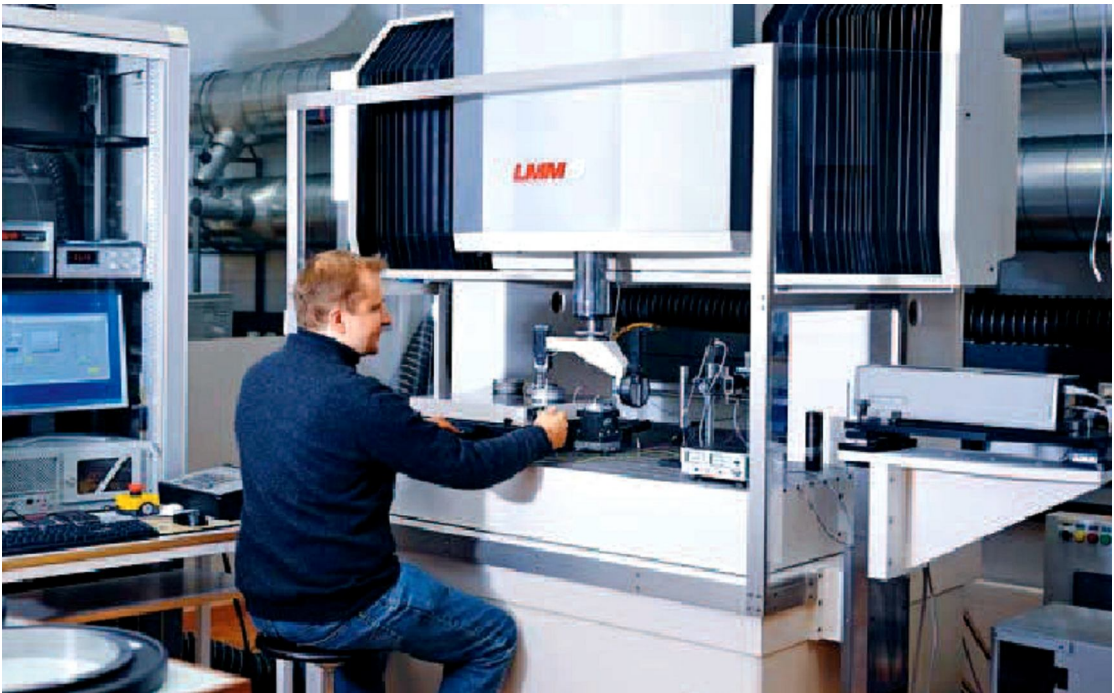
Рисунок 1.11 – Машина для измерений длины SIP LMM5, METAS, Швейцария
