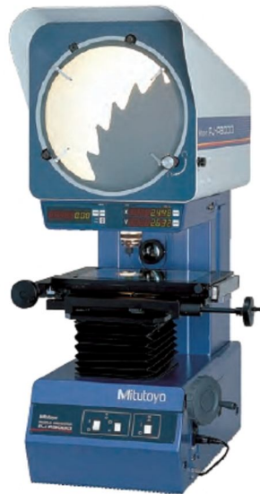
Рисунок 1.21 – Измерительный проектор Mitutoyo (Япония) PJ-A3000 (а), аксессуар для измерений деталей вращения (б)
