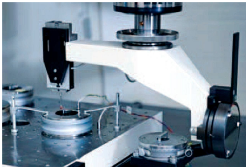
Рисунок 1.12 – Патрон машины SIP LMM5 с контактным измерительным щупом
