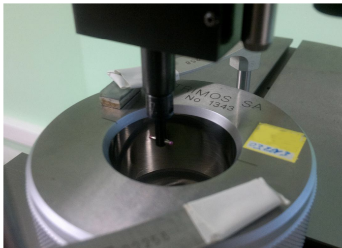
Рисунок 2.9 – Передача единицы длины от эталонного измерительного кольца
