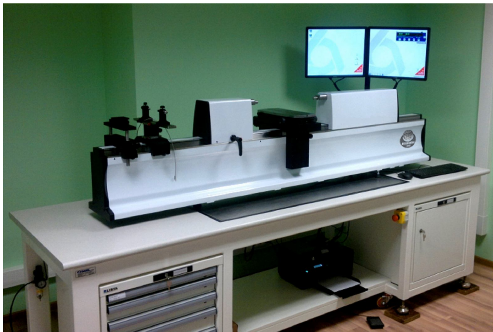
Рисунок 2.3 – Общий вид установки ВНИИМ для измерений среднего диаметра резьбовых калибров
